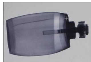
Munition récupérée au troisième point d'impact et sa radiographie
